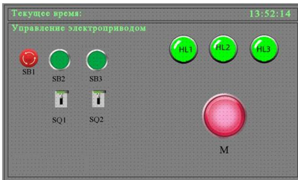
1. Нажать (короткое нажатие) SB3 => Лампа HL3 мигает с частотой 1 Гц, лампа HL2 выключается. Происходит отсчет 5 сек задержки => М вращается в прямом направлении, лампа HL1 горит.
