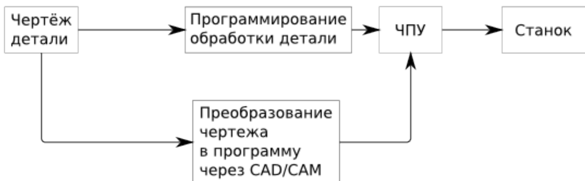
Рис. 1.1.1: Обработка детали на станке
