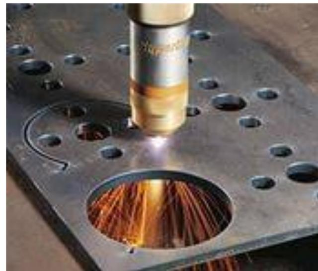
Плазменной дугой режут коррозионно-стойкие и хромоникелевые стали, медные, алюминиевые и другие сплавы.
