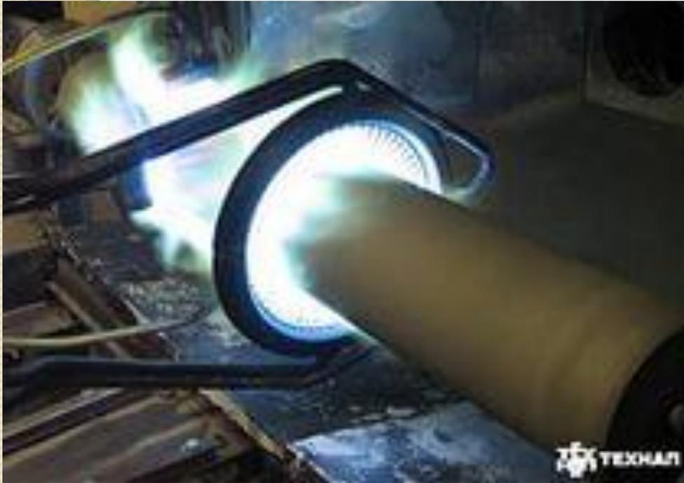
Используется для нанесения покрытий из любых тугоплавких материалов.
