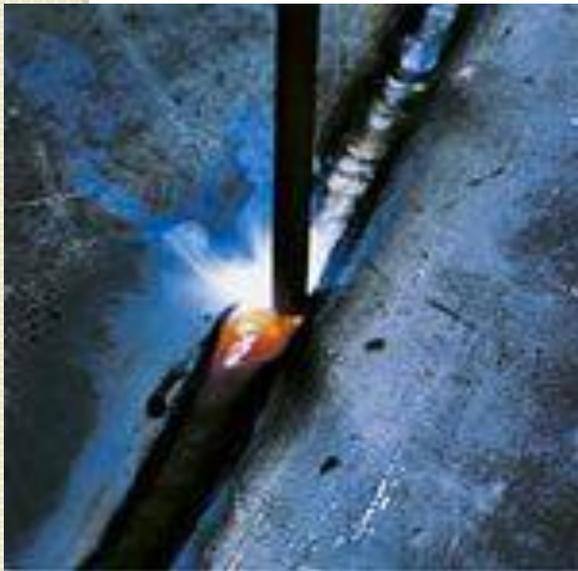
Сварка – технологический процесс получения неразъёмных соединений, характеризующихся междуатомной связью, путём отдельного или совместного приложения тепла и давления.
