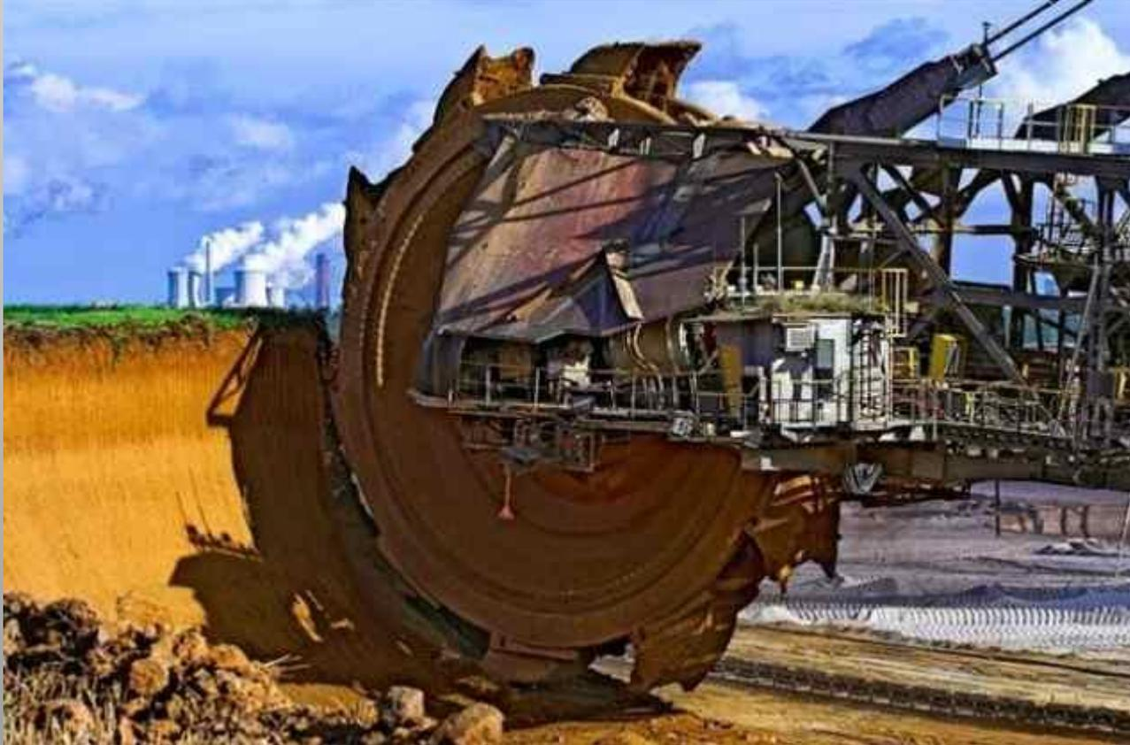
Крупнейший экскаватор в мире Bagger 288 убирает слой грунта перед угледобычей в Тагебау Хамбах, Германии.
