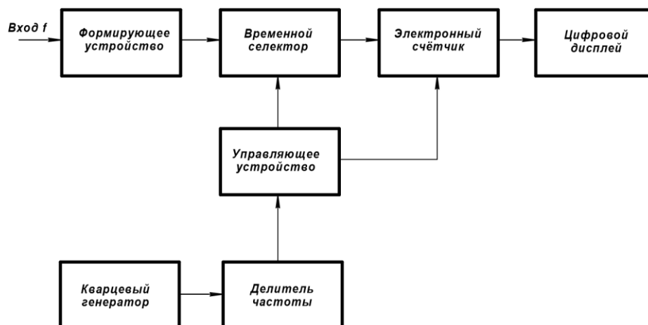
Рисунок 46 - Структурная схема частотомера
