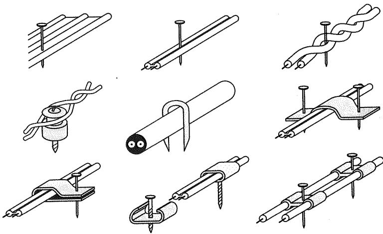
Рис. 1.10. Крепежи для электропроводки
