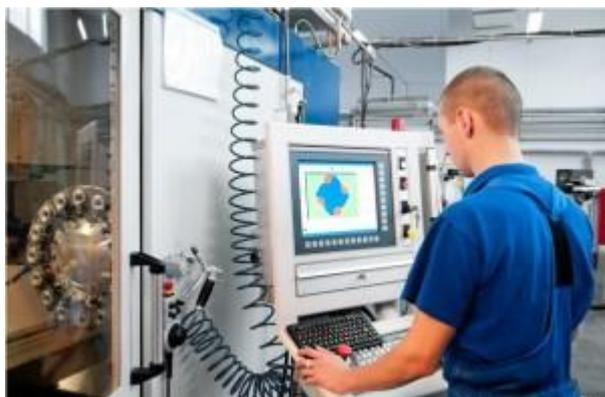
являются станки с программным управлением. По заданной программе станок выполняет нужную последовательность операций, а обслуживает этот станок оператор. Применение станков с программным управлением обеспечивает высокую степень автоматизации обработки изделий, улучшает их качество, точность, повышает культуру производства. Современный уровень развития
